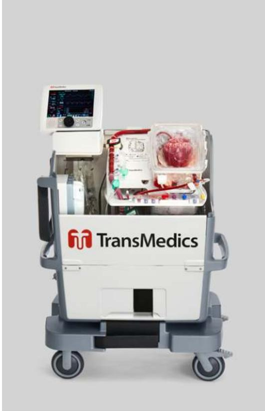
**Perfusion par machine ex vivo sur roulettes. Les appareils permettent de prolonger le temps de transport des organes (ici, le cœur) et de réparer des lésions mineures.**
